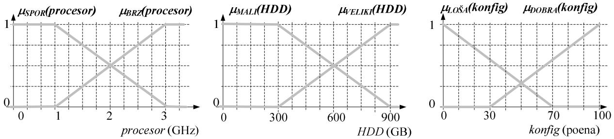
**Pravilo 1:** IF *procesor* IS *SPOR* OR *HDD* IS *MALI* THEN *konfig* IS *LOŠA*
