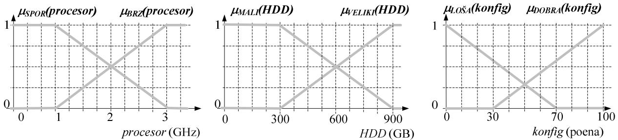
**Pravilo 2:** IF *procesor* IS *BRZ* AND *HDD* IS *VELIKI* THEN *konfig* IS *DOBRA*
