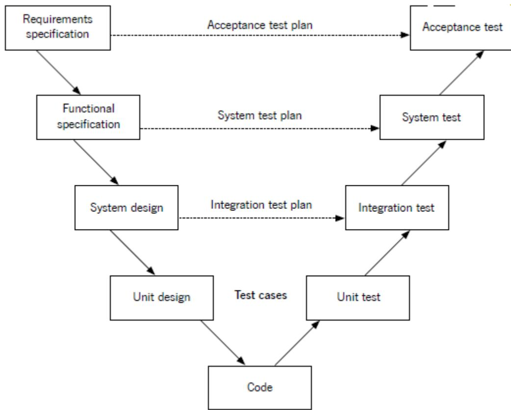
V-model kao i vodopad ima sve sekvenčne faze analize, dizajna, programiranja i testiranja gde se u sledeću fazu prelazi samo ako je završena prethodna, ali uz dve značajne izmene:
