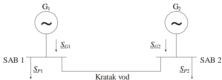
Sl. 4.20 Primer dvosabirničkog sistema, aktivnog na oba kraja, povezanog kratkim vodom
